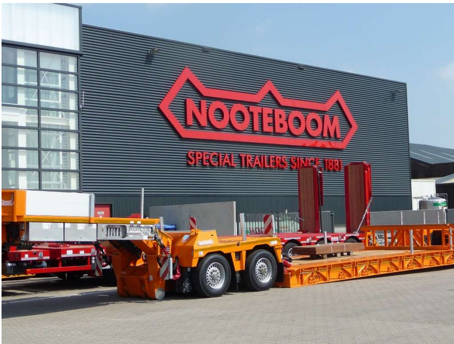
Schwerlasthänger mit Lenkachsen, vor der Werkhalle der Nootboom Trailer .
